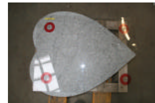
Fotografieren einer Kontur mit mobiler Schablone
